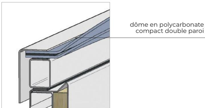
**Fig. 43** Remplissage d'un lanterneau ponctuel: dôme en polycarbonate compact double paroi
